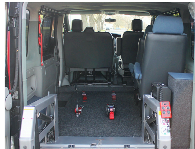
Exemple d'aménagement intérieur du véhicule TPMR
