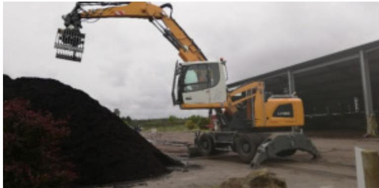
Pelle hydraulique industrielle sur pneus avec cabine réhaussée
