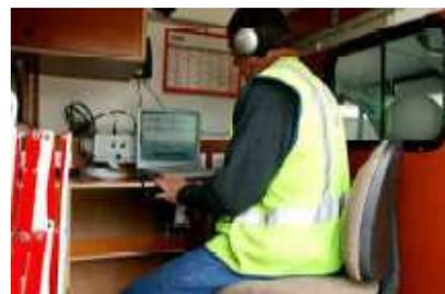
Une fois ces détections réalisées, une cellule spécialisée dans la recherche par corrélation acoustique intervient afin de localiser la fuite précisément avant de procéder à sa réparation.
