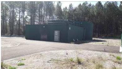
Cette station est composée d'un surpresseur équipé d'une bache de 620 m<sup>3</sup> et de 3 pompes à vitesse variable. Il assure l'alimentation des réseaux des quartiers de Sylvabelle, Balanos et Lamothe sur l'est de la COBAS.
