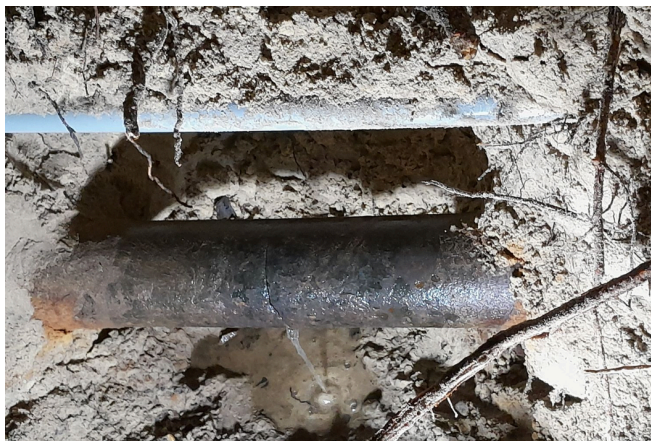
Fuite Fonte grise DN100 - Case franche - Coquille de réparation
